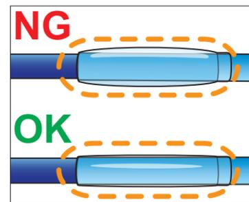
7 カテーテルのバルーンが完全に収縮していることを確認する。収縮していなければ陰圧を掛け、完全に収縮させる。
