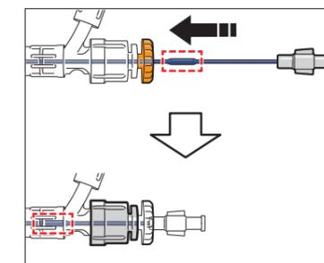
3 ダイレーターをスマートコネクタNV内に、突き当たるまで挿入する。
